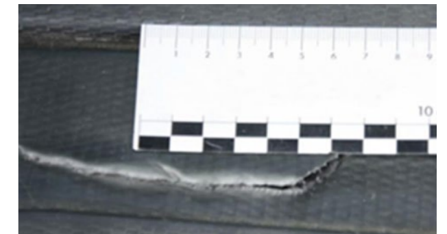
Perforazione dei profilati in plastica rigida. Riparazione dei profilati in plastica rigida in 1 ora (forfait), se esteticamente accettabili e riparabili
