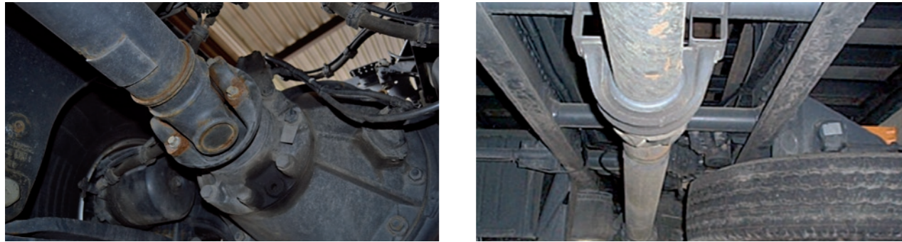
Segni di usura che non compromettono la sicurezza su strada
