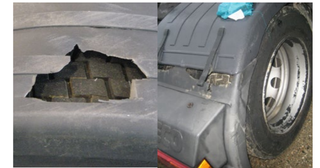
Rimozione di materiale, componente rotto
