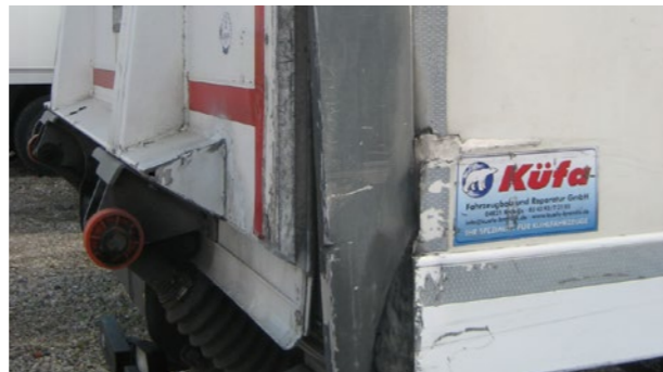
🔧 Porte laterali e posteriori: deformazione rilevante: tempo di riparazione > 1 h e riparazione economicamente conveniente, chiusura non a tenuta
