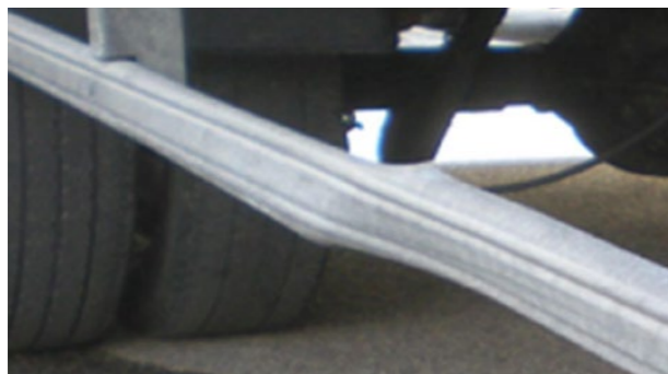
↻ Barre di protezione: deformazione dalla riparazione antieconomica
